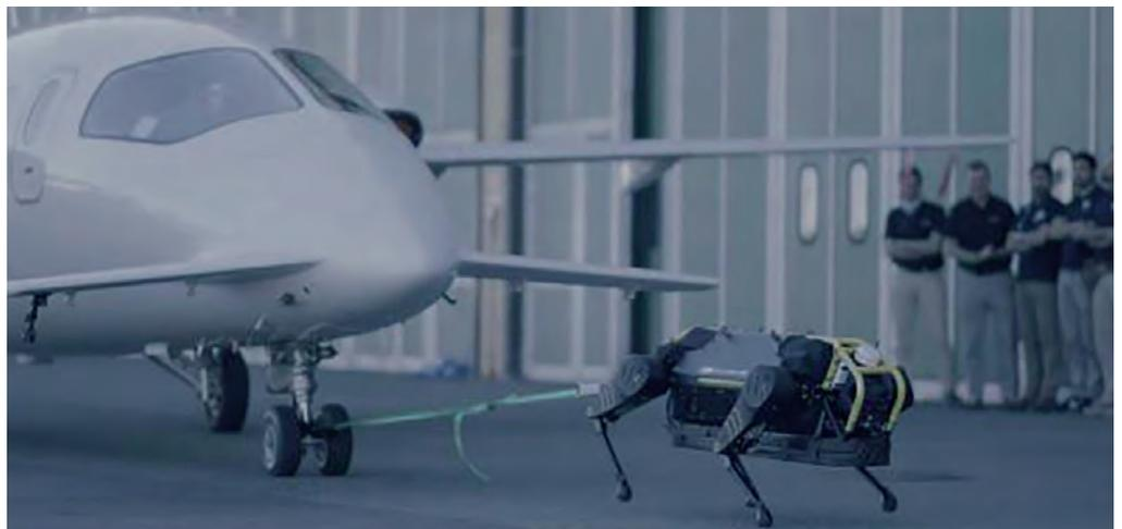
HyQReal, lungo 1,33 metri, alto 90 cm e con un peso di 130 kg, è protetto da una gabbia in alluminio e dotato di una pelle in Kevlar, fibra di vetro e plastica. Il quadrupede ha zampe resistenti all'acqua e alla polvere, dotate di una gomma speciale che permette un'elevata trazione sul terreno. È dotato
